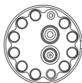
JA 10CH OPTICAL 2CH AWG16
